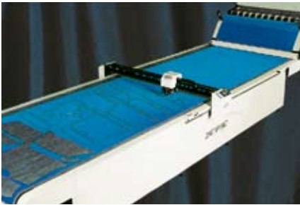
Flux continuu de material: alimentare, tăiere, descărcare pe o bandă non-stop.
