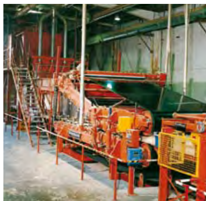
Bandă cu presă de preformare în producția de plăci aglomerate. Covorul din pastă de fibre lemnoase este precomprimat în timpul transportului către presă.
