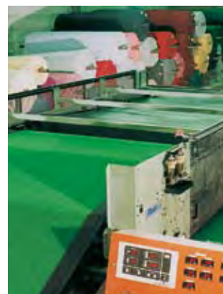
Stivuirea încrucișată a straturilor de materiale nețesute în industria Nonwoven. O mare viteză de producție și o accelerație puternică a masei – la transportul direct al firelor nețesute între benzi – impun benzilor tehnologice exigențe maxime.
