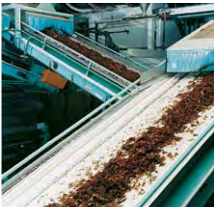
Transport pe plan înclinat în industria tutunului. Până la o înclinare de 22° pot fi utilizate în acest domeniu și tipurile de bandă cu suprafață netedă.
