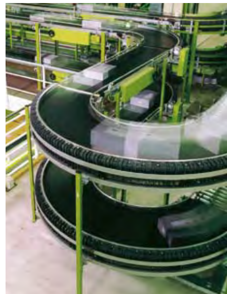
Transportor în curbă cu chingi într-un centru de distribuție
