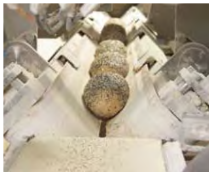
În marile întreprinderi de panificație iau naștere produse cu forme rotunde cu ajutorul vitezelor diferite ale benzilor.
