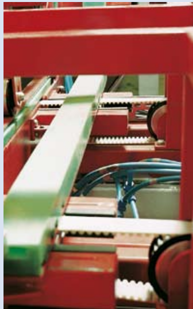
Transport de pare-brise par entraînement synchrone. Le revêtement de la face lisse de la courroie dentée préserve le produit transporté et améliore l'entraînement.
