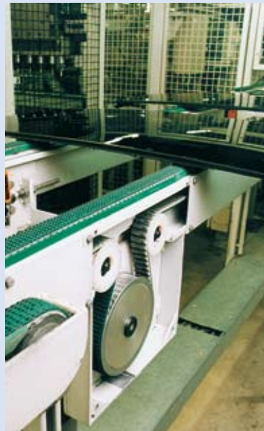
Transport de pare-brise par entraînement synchrone. Le revêtement de la face lisse de la courroie dentée préserve le produit transporté et améliore l'entraînement.
