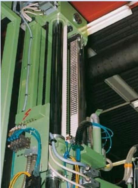
Courroie dentée Siegling Proposition en axe vertical sur un robot industriel.
