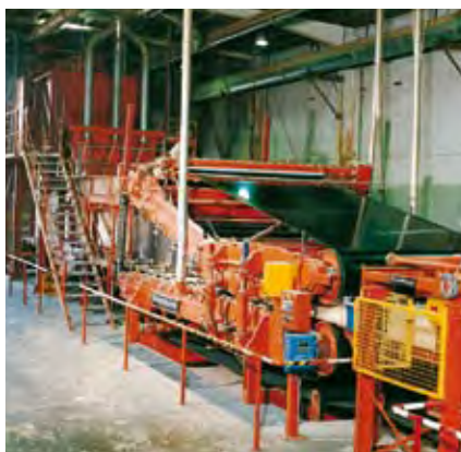
Bande de pré-presses pour la fabrication des panneaux de particules. Le gâteau de particules est pré-compressé pendant le transport jusqu'à la presse.
