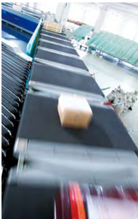
Trieur transversal à bande dans un centre de distribution. L'accélération élevée exige des coefficients de frottement extrêmement bons de la surface de la bande.
