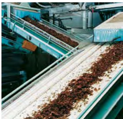
Transport sur plan incliné dans l'industrie du tabac. Certaines bandes avec surface lisse peuvent être utilisées dans ce domaine d'activité jusqu'à un angle d'inclinaison de 22°.
