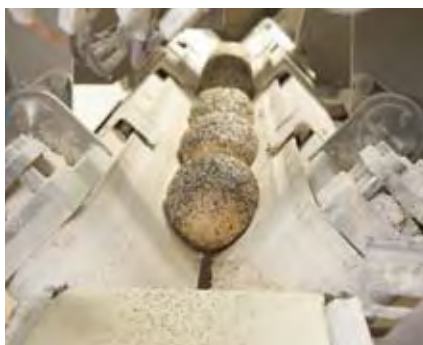
En boulangeries industrielles, les pâtons sont formés grâce aux différentes vitesses de bandes.
