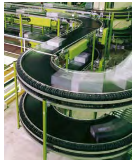
Convoyeur courbe dans un centre de distribution.
