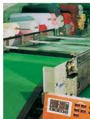
Etaleur-nappeur dans l'industrie des non-tissés. La vitesse de production élevée et les accélérations des masses lors des mouvements alternatifs pour le guidage du voile accroissent les exigences des bandes de process utilisées.
