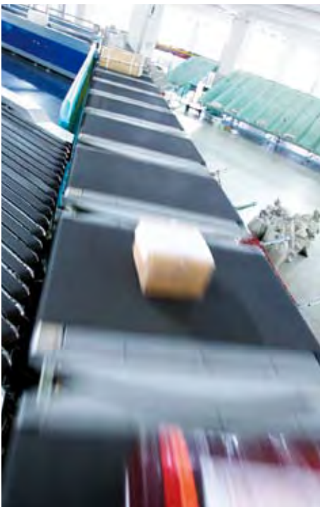
Equipo de selección transversal en un centro de distribución. La alta aceleración exige valores de rozamiento extremadamente favorables de la superficie de banda.
