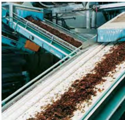
Transporte inclinado en la industria tabaquera. En esta zona se pueden emplear tipos de banda de superficie lisa con ángulos de hasta 22°.
