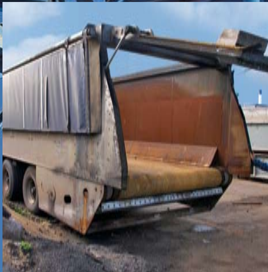
Entladeband für 40 Tonnen Steinkohle. Erst Siegling Transtex macht diese kompakte Anlagenkonstruktion möglich.
