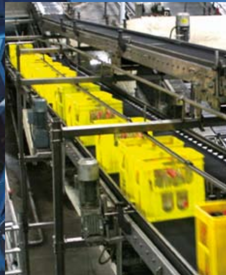
Auch bei sehr hoher Beladung und nassem Fördergut können große Steigungswinkel realisiert werden.
