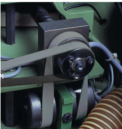
Streckenantrieb (Textilindustrie/Garnherstellung), Bandtyp GG 20E-20 NSTR/FSTR grau/schwarz
