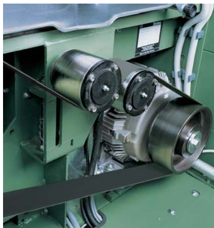
Streckenantrieb (Textilindustrie/Garnherstellung), Bandtyp GG 20E-20 NSTR/FSTR grau/schwarz
