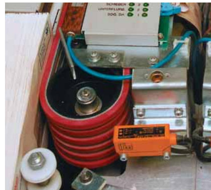
Siegling Linpack Riemen im Einsatz auf Briefverteilanlagen.
