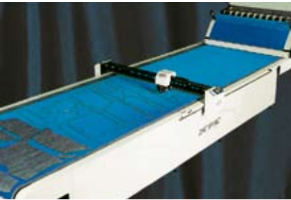
Kontinuierlicher Materialfluss: legen, schneiden und ablegen auf einem durchgehenden Band.
